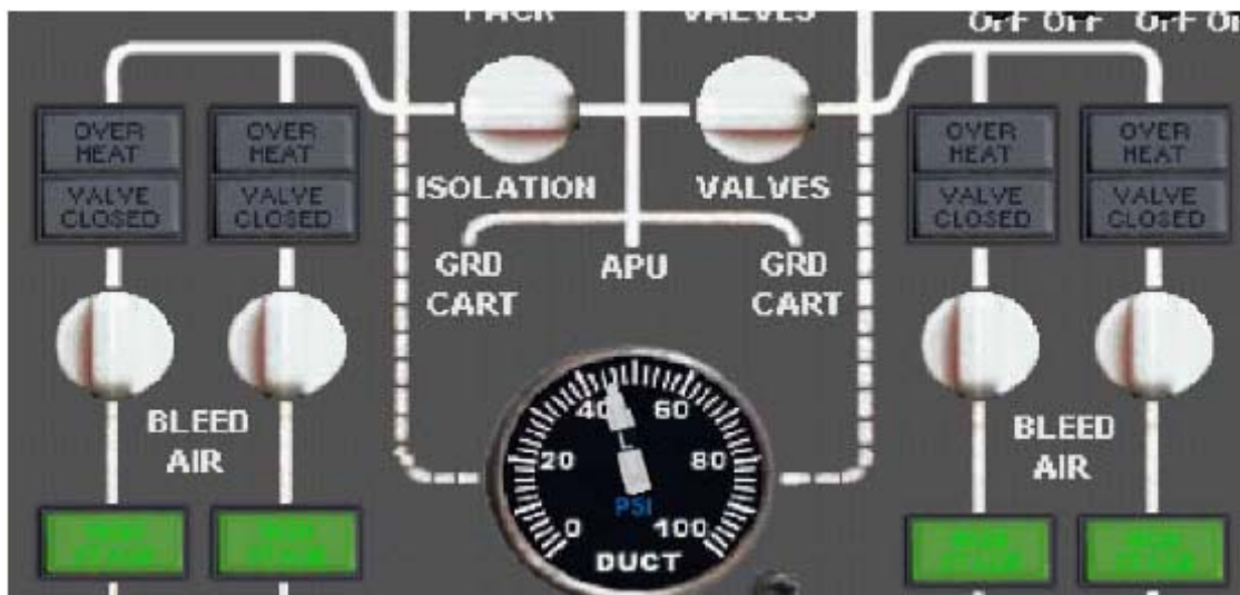
Figure 21 : Interrupteurs d'air de prélèvement et vannes d'isolation, position avant vol
