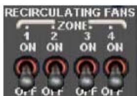
Figure 10 : Ventilateur de circulation d'air
