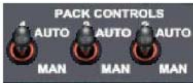
Figure 11 : Indicateurs et contrôle de l'air conditionné
