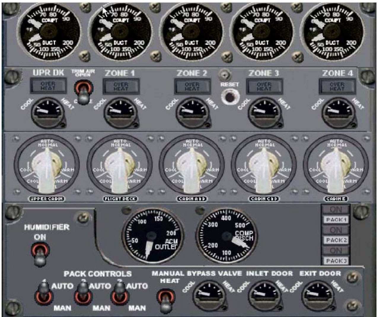
Figure 1: Tableau de l'air conditionné et de la pressurisation
