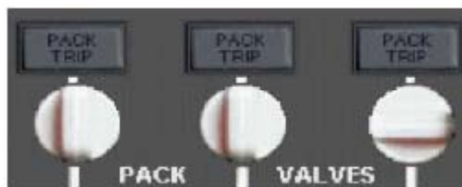
Figure 26 : Vannes de groupe
